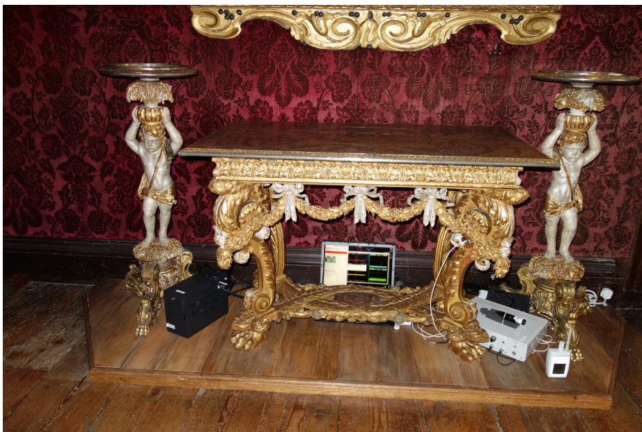
Fig. 5 Table de l'ensemble Gole et torchère dans la Galerie Cartoon avec équipement de surveillance d'EA. Les capteurs d'EA sont connectés à l'amplificateur (à droite), lui-même relié par l'interface PCI (à gauche) à l'ordinateur portable (au centre, derrière). Le capteur Hanwell T et le capteur d'HR sont temporairement localisés au premier plan. (© National Trust)
